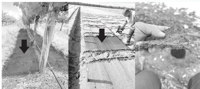
Màng phủ SBPM được thực hiện thử nghiệm trên vườn nho (hình trái), đất cát trồng cà rốt (hình giữa) và độ dày màng sau phun (hình phải) (Truyền Võ, DPRID)
